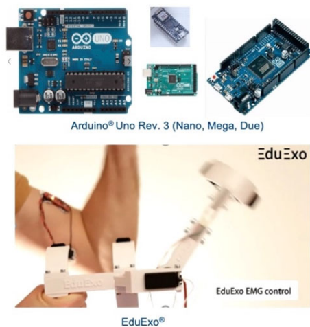
Abb. 2: Praktikum "Grundlagen der Biomechanik" in Präsenz: Aufbau eines Regelkreises zur Ansteuerung eines Exoskelettes mit EMG-Daten
