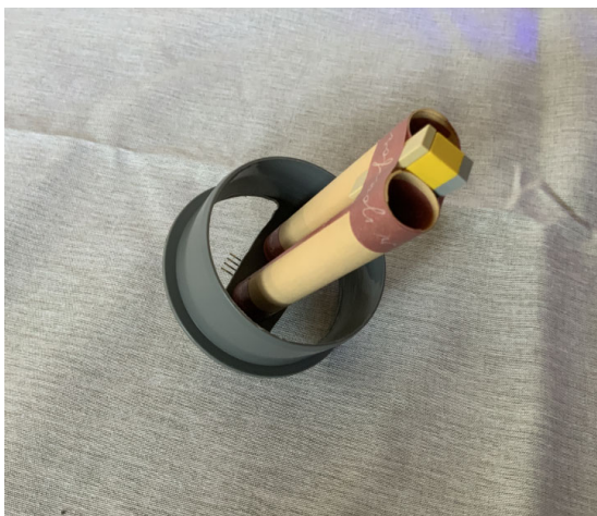
Abb. 7: Ultraschallsensor mit verkleinertem Abstrahlwinkel zur Reichweitenverlängerung [3.]
