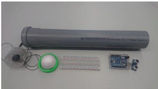
Abb. 3: Komponenten des ersten Prototyps aus Hochtemperaturrohr, Föhngebläse, Styroporball, Arduino und Ultraschallsensor. Die Steckplatine vereinfacht die Verkabelung aller Bauteile. Eine 3D-gedruckte Fassung dient zur Befestigung des Gebläses an dem Rohr.
