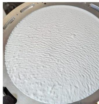
Abb. 6: Vliesschicht nach Beenden des Abscheideprozesses
