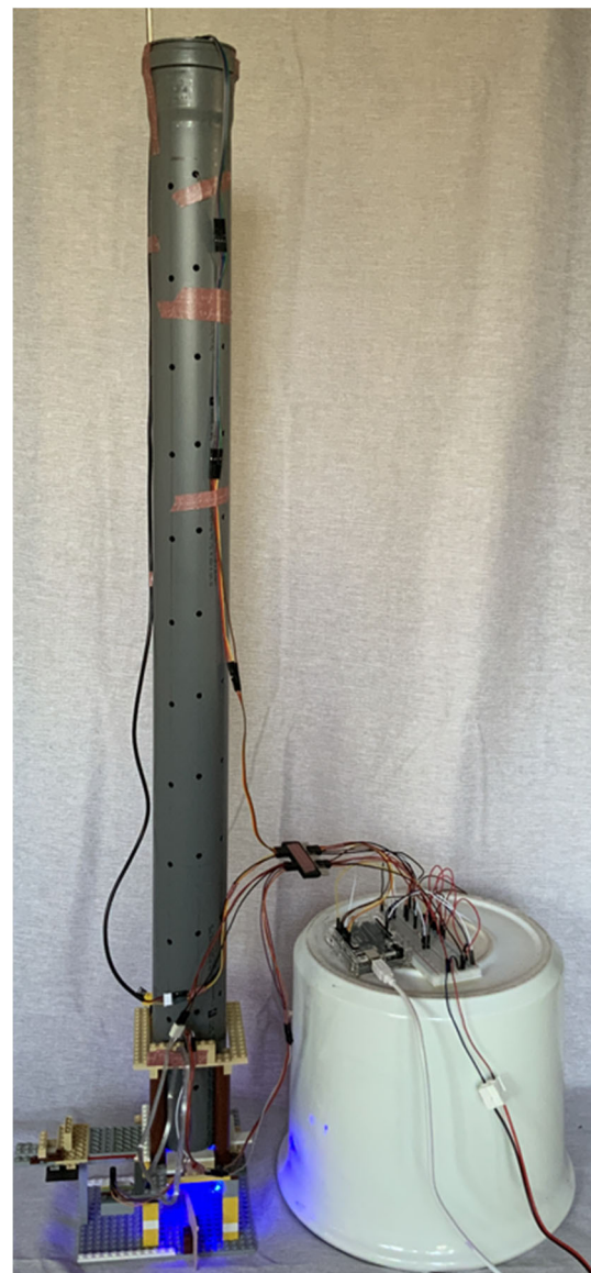
Abb. 5: Studentischer Eigenbau aus einem Hochtemperaturrohr und Klemmbausteinen [3.]
