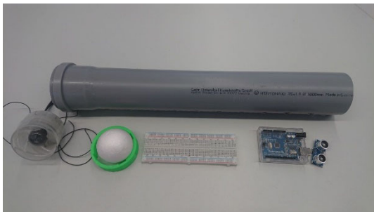
Abb. 3: Komponenten des ersten Prototyps aus Hochtemperaturrohr, Föhngebläse, Styroporball, Arduino und Ultraschallsensor. Die Steckplatine vereinfacht die Verkabelung aller Bauteile. Eine 3D-gedruckte Fassung dient zur Befestigung des Gebläses an dem Rohr.
