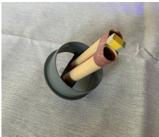
Abb. 7: Ultraschallsensor mit verkleinertem Abstrahlwinkel zur Reichweitenverlängerung [3.]
