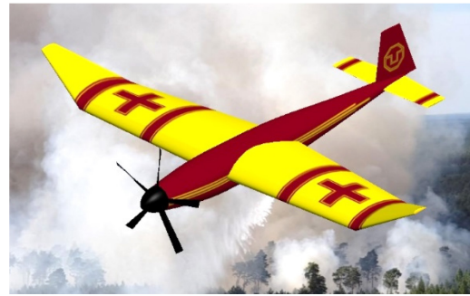
Abb. 6: Finaler Entwurf der Gruppe mit V-Stellung in den Außenflügeln zur Verbesserung der Spiralstabilität
