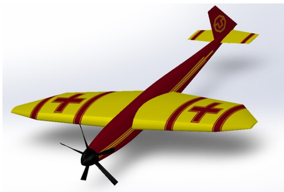
Abb. 3: sUAS vor dem CDR, noch ohne die spätere V-Stellung der Außenflügel (vgl. Abb. 6)
