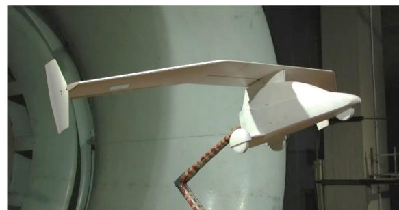
Abb. 9: Schwanzloses Fluggerät mit etwa 2 m Spannweite im Windkanal der TU Dresden
