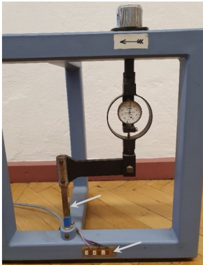
Abbildung 1: Aufbau des Laborpraktikums "Dehnungsmessung". Die Positionen der Dehnungsmessstreifen sind durch Pfeile markiert.
